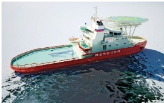
Baltica är det första fartyget i världen som kan gå sidlänges och bryta upp en ränna som är 50 meter bred.
