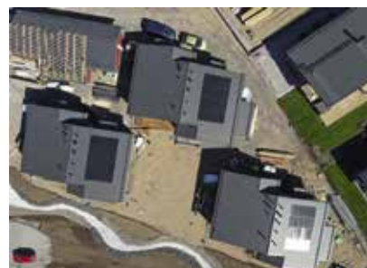
Ormax Aurinkokatossa aurinkopaneeleja ei asenneta katon päälle, vaan ne ovat samalla osa vesikattoa. Kuva: BMI Group
