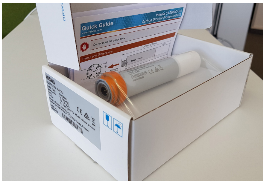
Paketissa on Vaisala CARBOCAP-anturi hiilidioksidin mittaamiseen.
