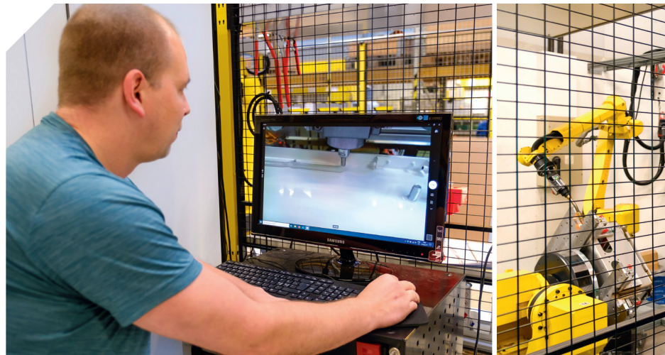
Darekon on investoinut vuosittain miljoonia euroja tuotantoteknologiaan, esimerkiksi robotteihin. Kuvassa työskennellään Klaukkalan tehtaalla uudella robottisolulla, jolla pursotetaan tiivisteitä muun muassa laitekaappien oviin.
