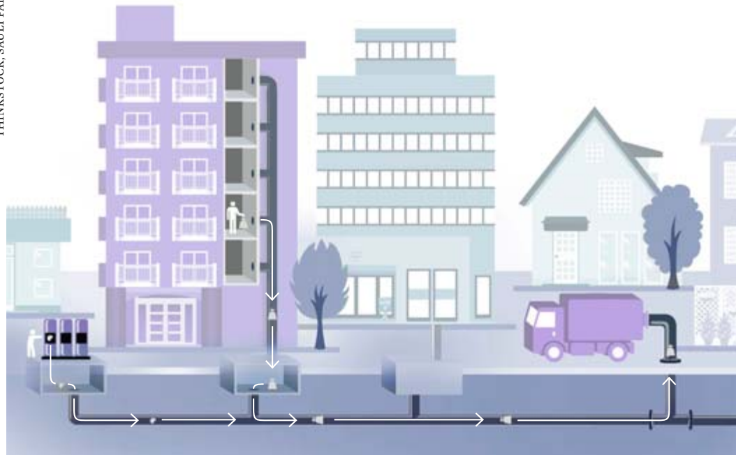
Keräysputkistoa pitkin kulkevat vuorollaan sekajätteet, biojätteet, paperit ja kartongit.
