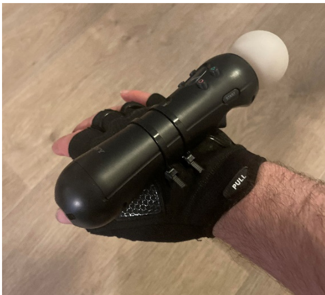
Eerik Kantokoski valmisti itse opinnäytetyöhönsä ranteiden liikkeiden kaappaamiseen tarkoitettut hanskat.
