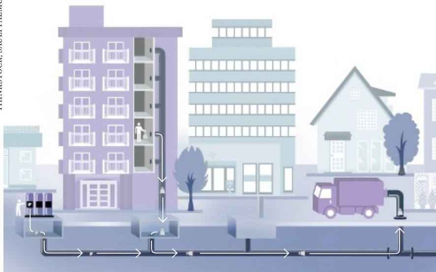
I avfallsröret transporteras invånarnas bioavfall, returpapper, returkartong och blandavfall.
