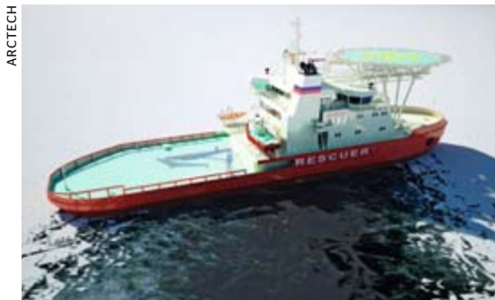
Baltika-alus on maailman ensimmäinen jäänmurtaja, joka kulkee kylki edellä ja murtaa 50 metrin levyistä väylää.
